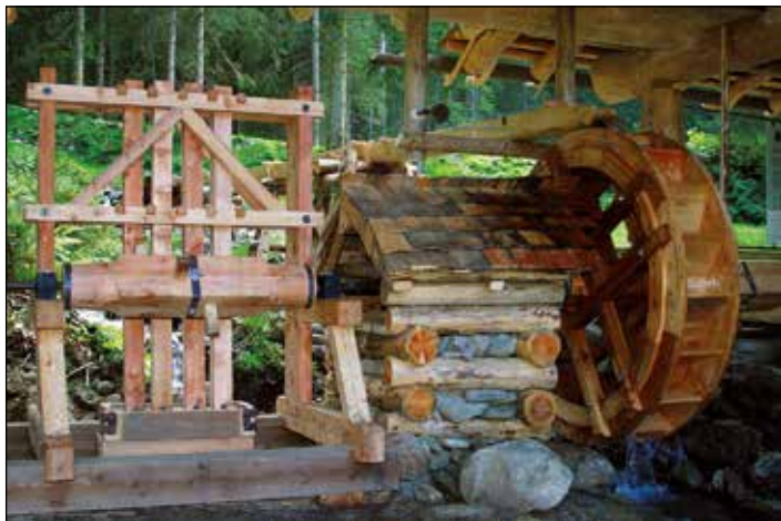
Der Pocher zerkleinerte das von der Erzweis angelieferte Erz bis zur Sandkorngröße - Schlich
